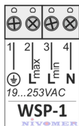
Rys. 5. Podłączenie sygnalizatorów WSP-1/C dla wyjścia typu bezkontaktowy przełącznik elektroniczny
